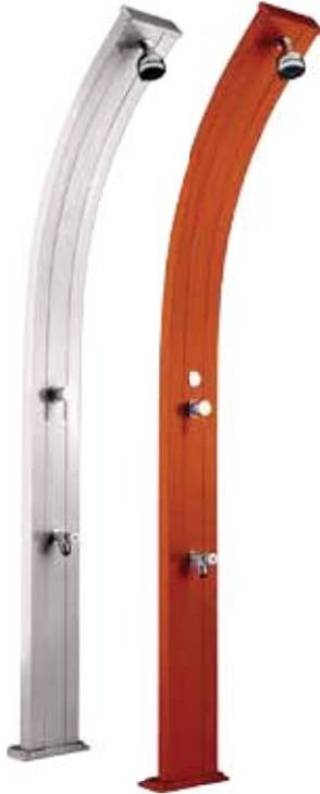
Realizzate completamente in alluminio e verniciate a forno per garantirne la durata, l'estetica e la qualità. Serbatoio capacità 30 l. Altezza 2,25 m. Dotate di miscelatore acqua calda/fredda. Ingresso acqua con portagomma universale.
